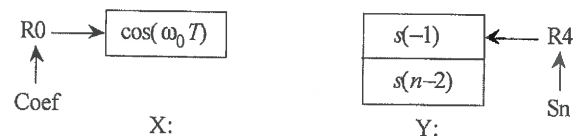
Fig. 4 - Structure de la mémoire du DSP.
