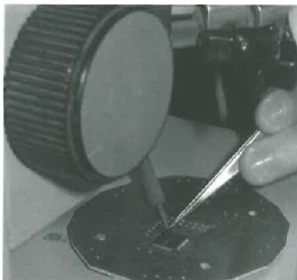
Fig. 7 : Soudage du microcontrôleur, carte de test.
