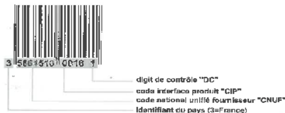
Figure 3 : Contenu d'un code EAN 13
