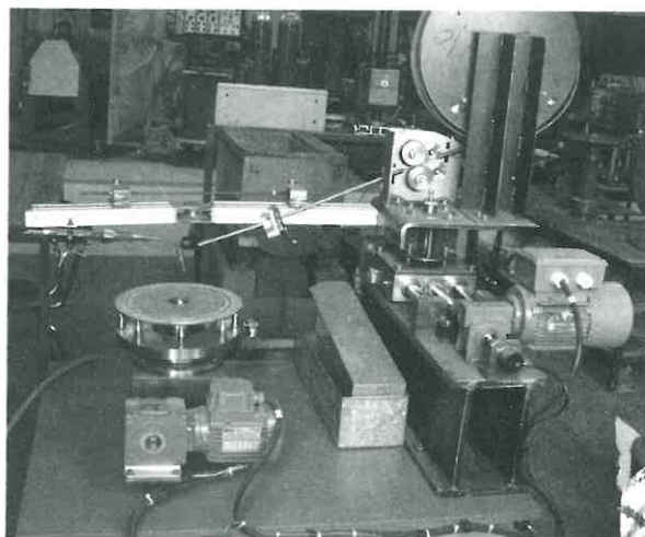
Photo 4 : Machine en cours de montage (photo du poste dépose de carbure : Figure 1)
