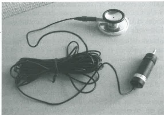
fig 1 : Solution d'acquisition du son : pavillon, micro et préamplificateur.
