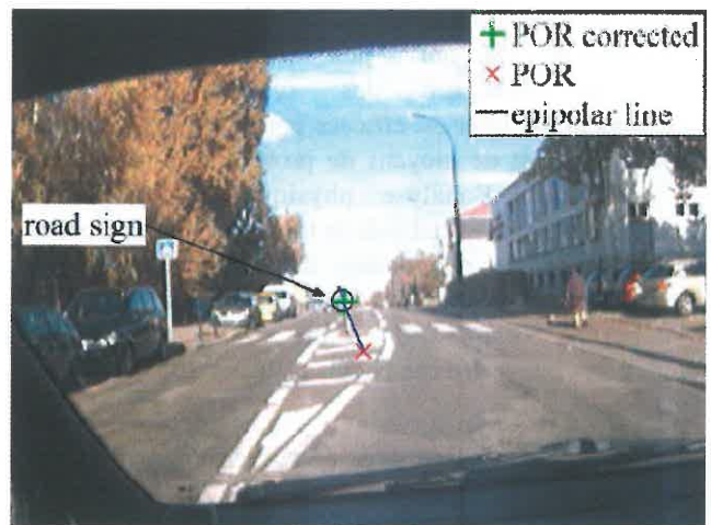
Figure 12 : Correction du parallaxe. En rouge la position du regard non corrigée. En vert la position du regard corrigée, montrant que l'utilisateur regarde le panneau.
