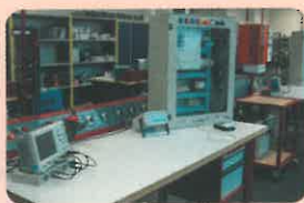
Maquette de variateur de machine à courant continu ABB utilisée en salle de TP d'électrotechnique et d'électronique de puissance.
