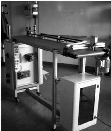
Figure 2 : La maquette de tri avec sa partie électrique et pneumatique
