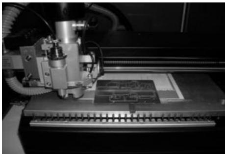
Figure 1 : Phase de gravure par ProtoMat
