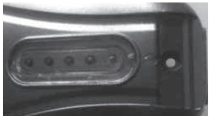
Une indication sur le coffret nous renseigne sur leur fonction : « 5 LED pour l'affichage de l'état de charge ou temps restant par paliers de 20%. ». Elles indiquent donc l'état de charge, bloc alimentation connecté ou l'état de décharge, bloc alimentation déconnecté, en utilisation rasoir. D'autres informations plus précises, écrites sur le coffret, concernant le temps de fonctionnement du rasoir et la durée de charge des batteries, peuvent être utiles :
