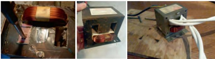
Cette tension 2.4V est absolument inoffensive au contact des doigts secs. On peut donc toucher les électrodes de notre forge sans aucun risque. (N'y mettez surtout pas la langue !!!)
