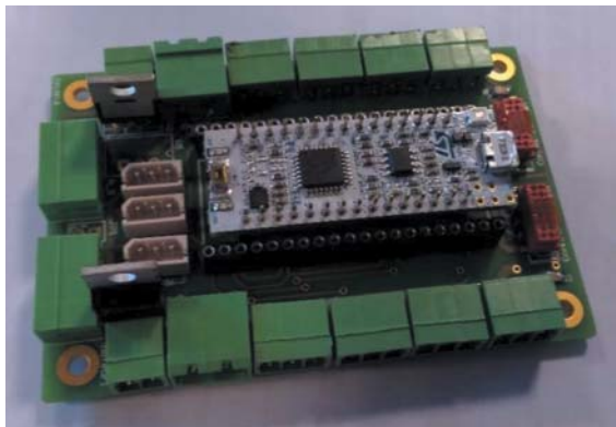
Figure 10 : Photo d'une carte capteurs/actionneurs en bus CAN
