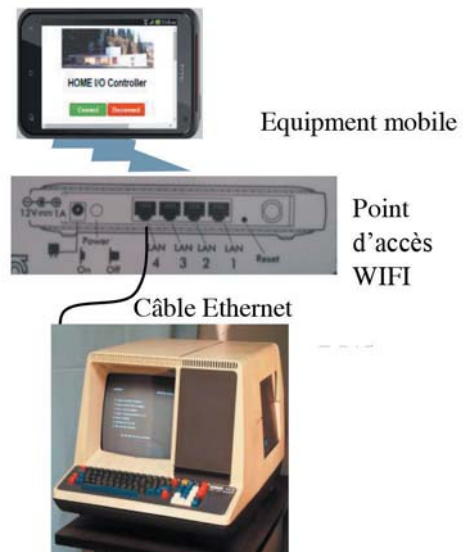
Figure 6 : Structure du réseau à mettre en oeuvre
