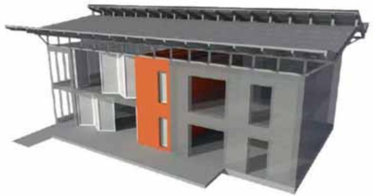
Figure 3 : Noyau technique préfabriqué en 3D et accueillant la cuisine, la SdB et le local technique. Dessin ENSAG
