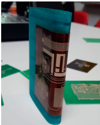
Illustration 3: Électronique sur film souple collé en surface de l'objet
