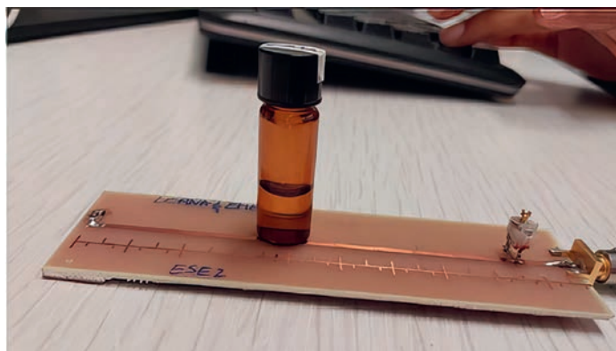
Figure 3 : capteur hyperfréquence de liquide, constitué d'une ligne microstrip graduée, la position sur la ligne de la fiole contenant de l'eau est optimisée pour avoir une réponse maximale, une capacité ajustable permet d'obtenir l'adaptation d'impédance.
