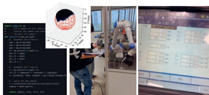
Figure 5. Prise de mesure, script Python réalisé par les étudiants résolvant un « sphere-fitting » et comparaison avec la méthode constructeur pour la calibration d'outil.
