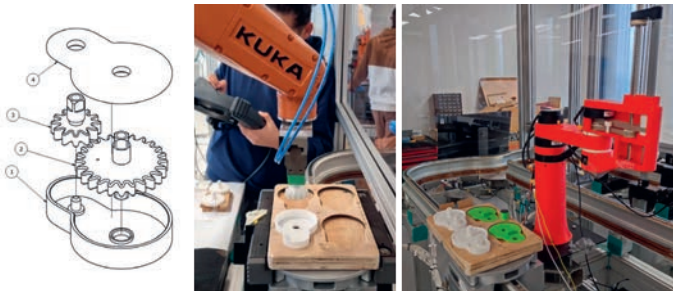
Figure 3 : Description et mise en œuvre lors du montage robotisé des éléments composant une boîte de vitesses.
